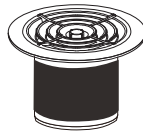
・室内排気口 (床面取付)
